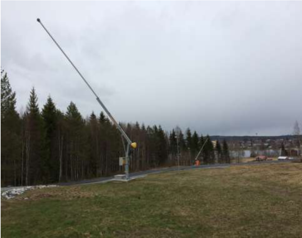
Lans 9 m med egen kompressor och automatiserad anläggning Filipstad. Foto Per-Åke Yttergård
