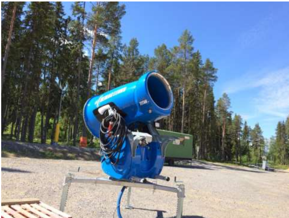
Fläktkanon automatiserad behövs traktor eller pistmaskin vid flyttning. Foto Per-Åke Yttergård
